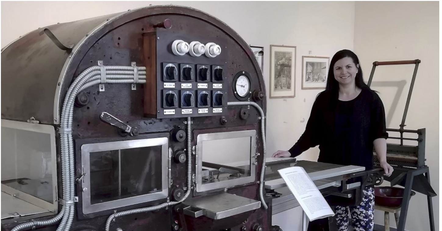
Bianca Schubert führt Gäste durch das Pulsnitzer Pfefferkuchenmuseum. Bald kann sie ihnen auch das neuste Schaustück zeigen. In dieser Maschine, die bis vor Kurzem noch in Betrieb war, bekommen Pfefferkuchen ihren Schokoüberzug. Foto: SZ/Reiner Hanke
